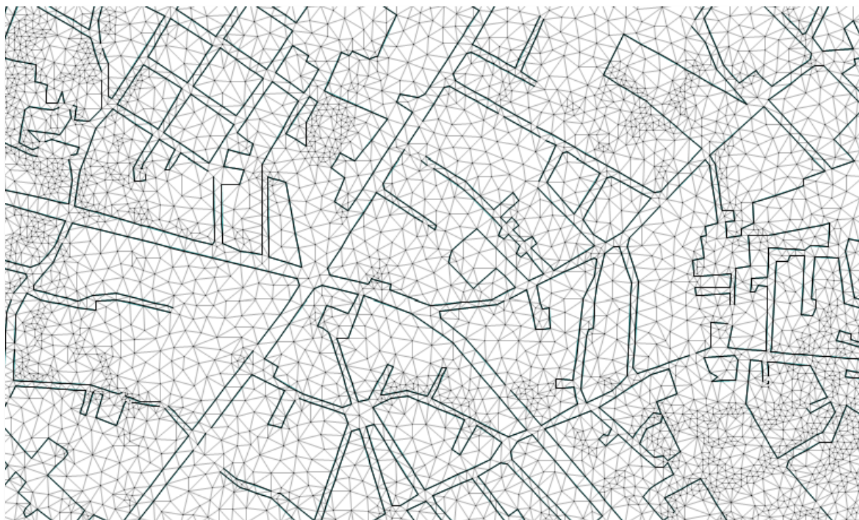
Figure 5 : Forçage du maillage du fait de l'intégration des limites de parcelles bâties en tant que murs poreux
