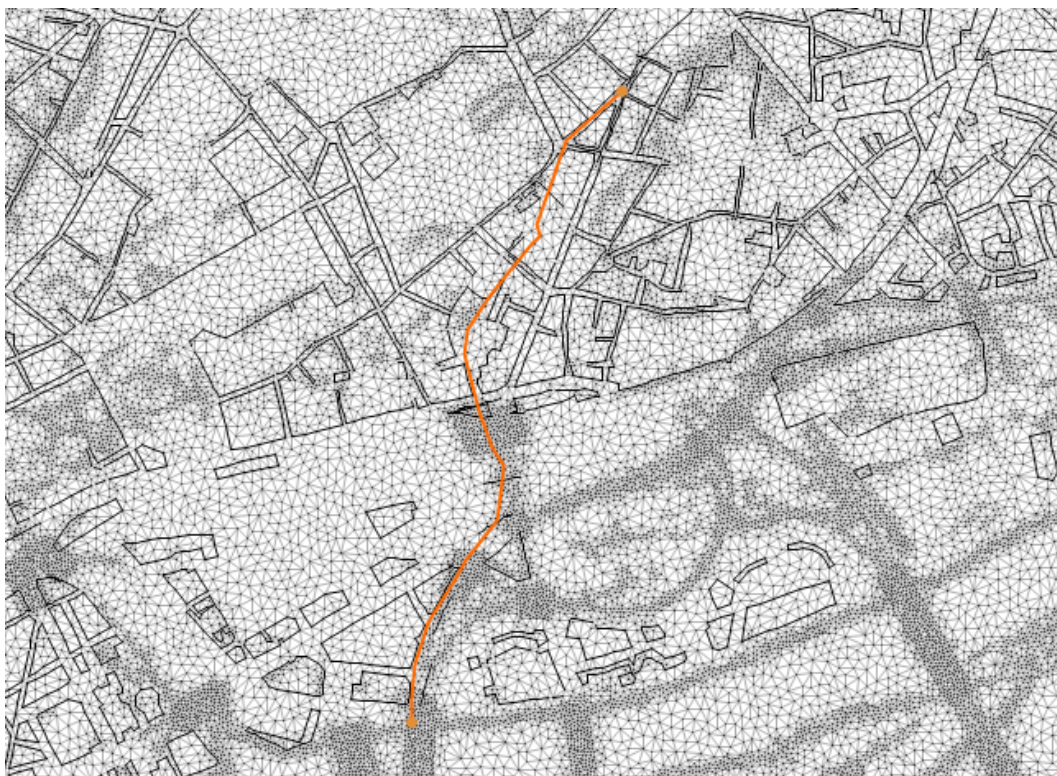
Figure 8 : Intégration de cours d'eau busé dans le modèle - exemple du Gué Robert
