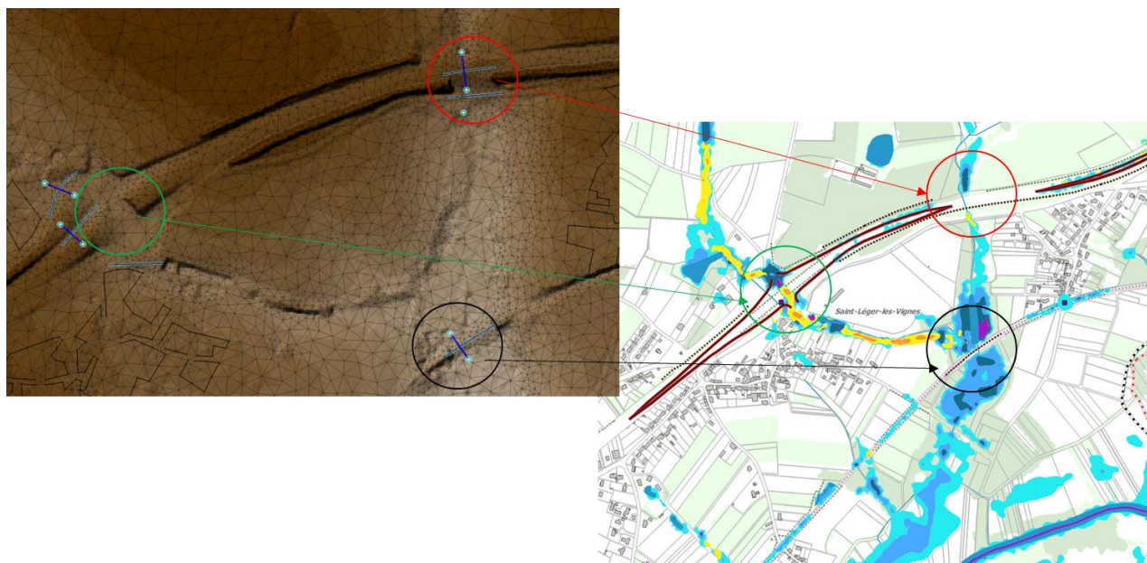
Figure 7 : Représentation des ouvrages de passage dans le modèle et influence sur la continuité des écoulements
