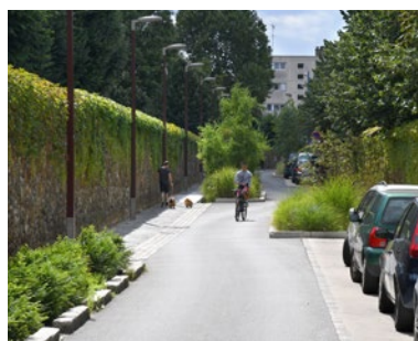
Noues végétalisées avec ruissellement direct
